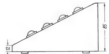
Gehäuseabmessungen und Einzelteilanordnung der Hauptstelle (Oben: Untenansicht, Deckplatte abgenommen, unten: Gehäuse-Seitenansicht)
