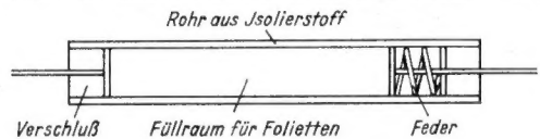
Bild 7. Siemens-Stabgleichrichter für 4000 Volt, 1 mA im Größenvergleich zu einem Bleistift; darunter Aufbau des Stabgleichrichters
